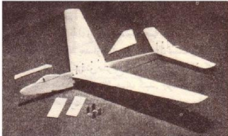
سطح بال را به بدنه بچسبانید بگذارید خشک شود. بعد قطعه دوزنقه ای بالای بال را نصب کنید سپس سکان عمودی را سوار کنید.
