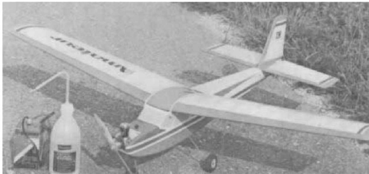
هواپیمای مدل مجهز به ارابه فرود سه چرخ ( یک چرخ جلو و دو چرخ در عقب )
