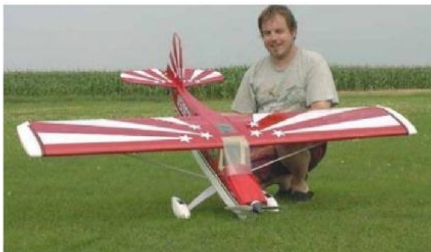
این هواپیمای مدل از بال مستطیلی شکل استفاده میکند
